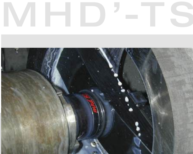
Fig. 2 – Com uma cápsula SSCC e um SMCC desencontrados e em diâmetros diferentes, para operações de desbaste com grande profundidade de corte.
