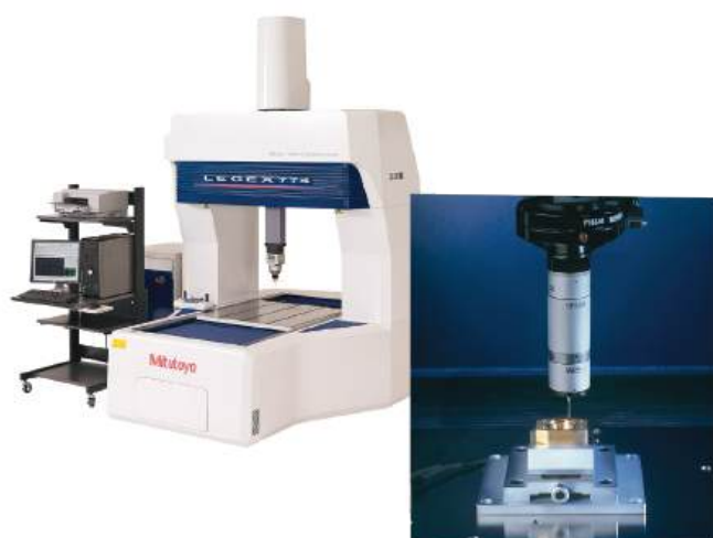
Máquina tridimensional Mitutoyo Legex 776.
