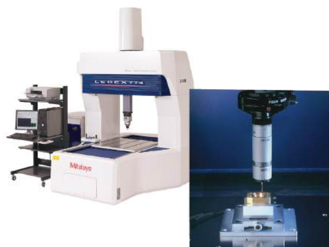
Máquina tridimensional Mitutoyo Legex 776.
