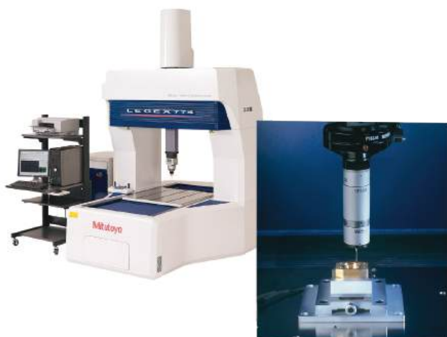
Máquina tridimensional Mitutoyo Legex 776.
