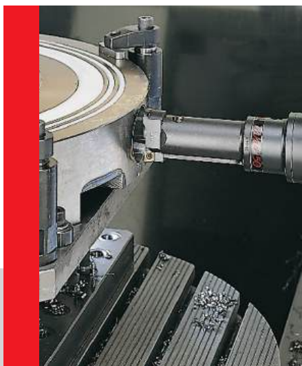
Fig. 1 – Com duas cápsulas SSCC alinhados e no mesmo diâmetro, para operações de desbaste com alta taxa de avanço.
